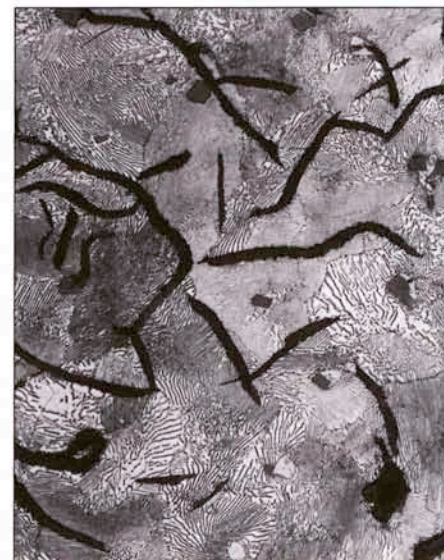
Bild 1: Die typischen Mikrogefüge von Gusseisen mit Lamellengraphit (GJL), links = ferritisches, rechts = perlitisches Grundgefüge jeweils mit eingelagerten Graphitlamellen; V = 200 : 1
