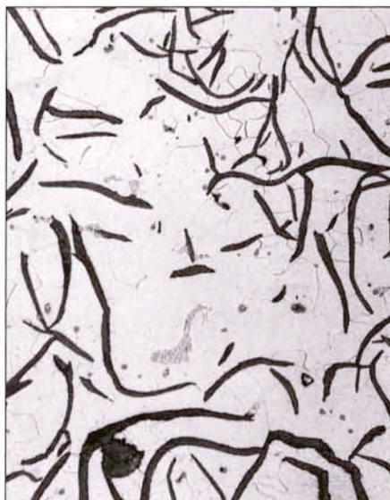
Bild 1: Die typischen Mikrogefüge von Gusseisen mit Lamellengraphit (GJL), links = ferritisches, rechts = perlitisches Grundgefüge jeweils mit eingelagerten Graphitlamellen; V = 200 : 1
